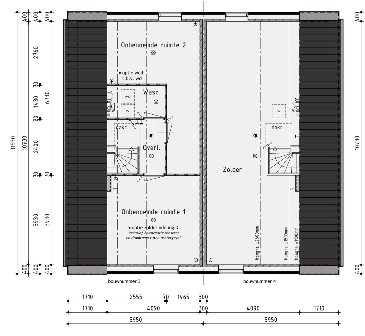
2de Verdieping v.z.v. vloerverwarming de onbenoemde ruimte(n) voldoen niet aan de eisen voor het verblijven van personen op het gebied van o.a. daglicht, ventilatie, hoogte boven de trap en plafondhoogte.
